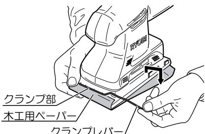
(注) 取付ける前に、木工用ペーパーに図のように折り目を入れておけば取付けが簡単にに行なえ、木工用ペーパーのたるみ防止にもなります。
